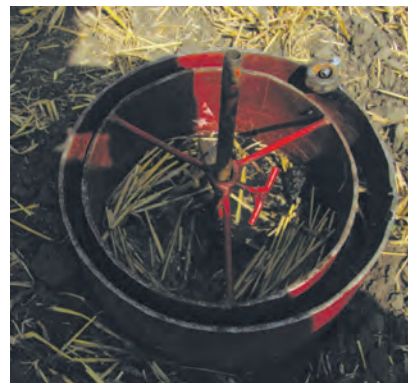
Рис. 2 – Пристосування для визначення водопроникнення ґрунту
