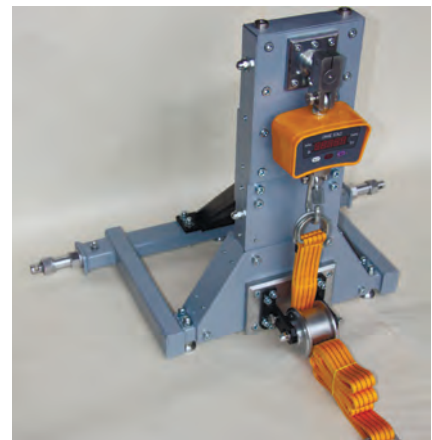
Рис. 1 – Пристрій для визначення тягово-зчіпних показників мобільних засобів: а – схема; б – загальний вигляд
