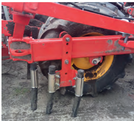
Рис. 4 – Загальний вигляд розрівнювачів колії
