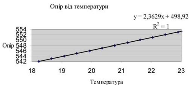
Рис. 2. Аналітична залежність терморезистора у діапазоні від 18\text{ }^{\circ}\text{C} до 23\text{ }^{\circ}\text{C}
