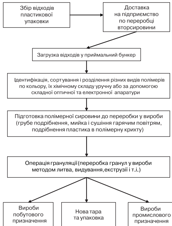
Рис. 7. Технологічний цикл операцій переробки полімерних відходів
