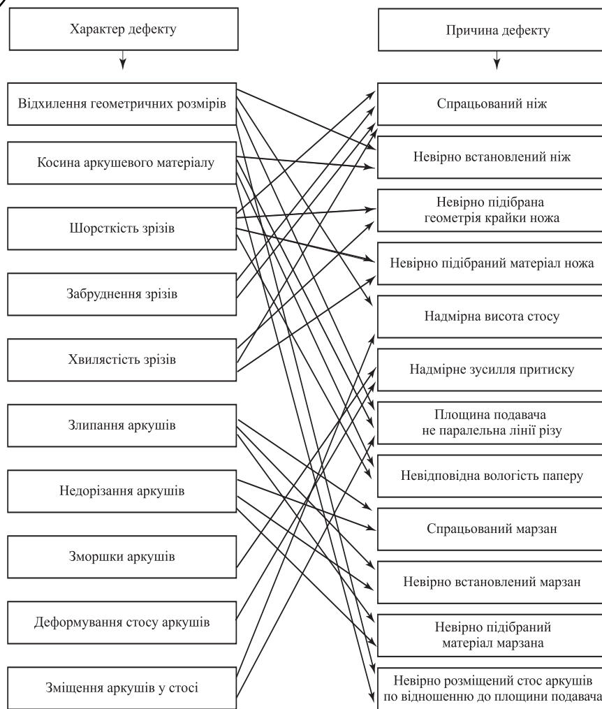
Рис. 1. Дефекти продукції, які виникають в процесі різання
