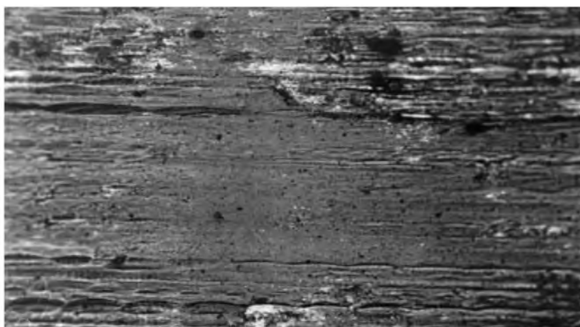
Рис. 5. Поверхня підшипника ковзання зі зносостійкого композиту 11РЗАМЗФ2 + (9 \div 12)\% \text{CaF}_2 , \times 200
