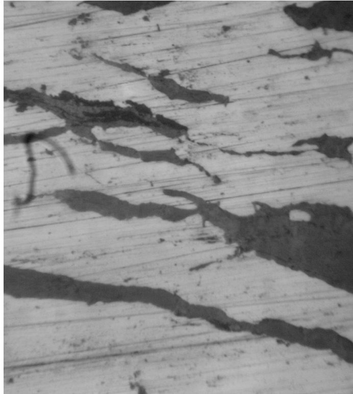
Рис. 2. Мікроструктура композиційного матеріалу Cu + 10 %C, \times 650
