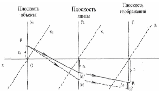
Рис. 3. Ход лучей в соединительном устройстве, построенном на микролинзах
