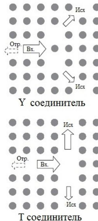
Рис. 2. Основанные на фотонных кристаллах, компактные элементы интегральных оптических цепей, направляющие оптическое излучение
