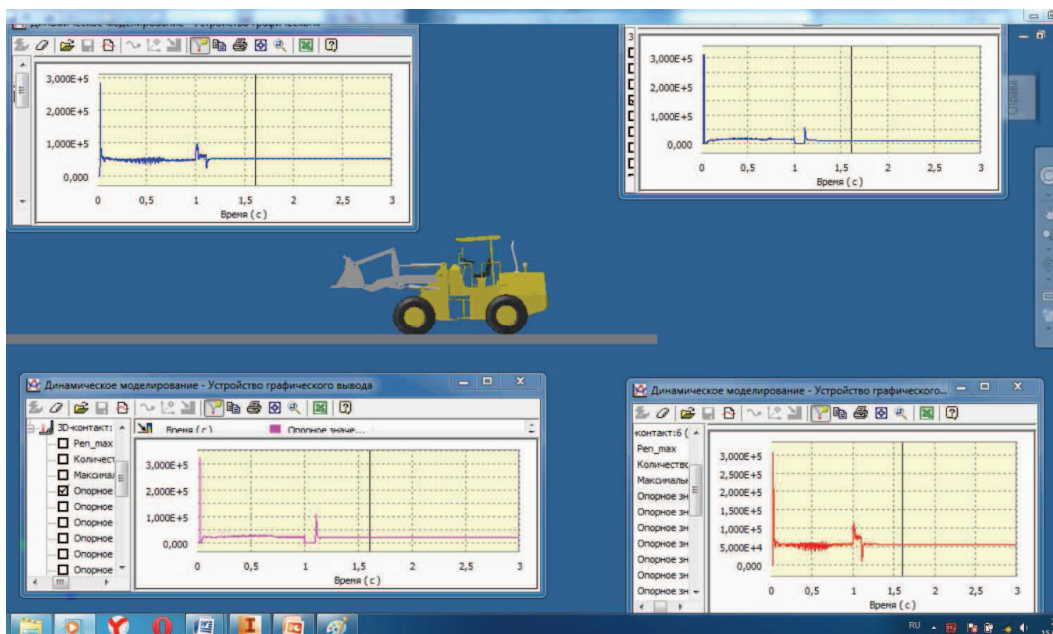
Рис. 10. Визначення опорних реакцій при різкому гальмуванні навантажувача Cat
