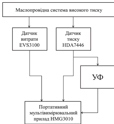
Рис. 6. Схема підключення узгодженого фільтра до вимірювальної системи НМГ3010
