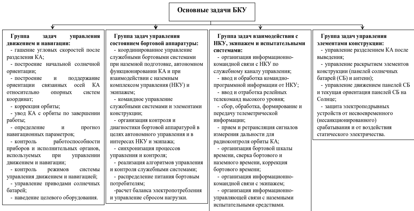
Рис. 1. Основные задачи бортового комплекса управления космическим аппаратом
