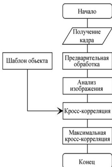
Рис. 2. Алгоритм поиска объекта с использованием кросс-корреляции [7]
