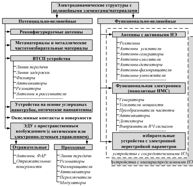
Рис. 1. Классификация электродинамических устройств
