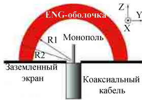
Рис. 14. Штыревой микроизлучатель с оболочкой из метаматериала
