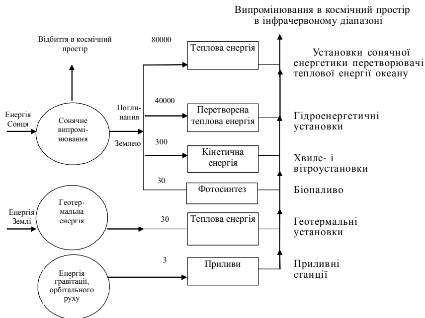
Рис. 2. Відновлювані джерела енергії та їх використання (числа позначають потужність джерела в тераваттах ( 10^{12} Вт))
