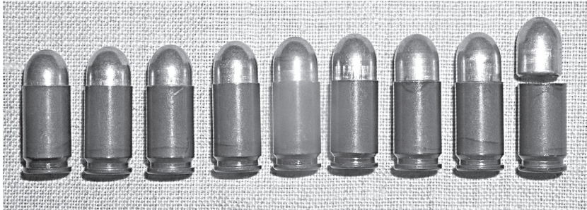
Рис. 4. Последовательность выхода пули из гильзы для различных величин извлекающего усилия
