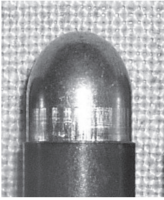
Рис. 1. Общий вид следов взаимодействия на поверхности пули патрона 9×18ПМ от дульца гильзы
