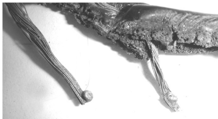
Рис 4. Внешний вид электропровода с термическими повреждениями
