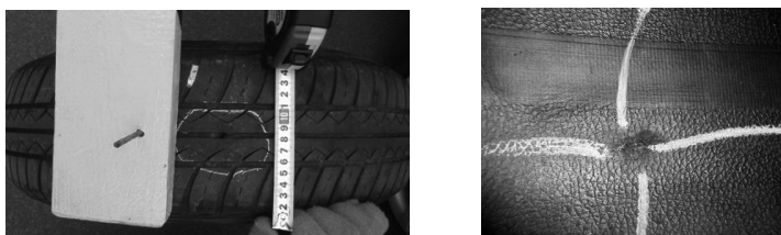
Рис. 6. Отвір в автомобільній шині, створений цвяхом \text{Ø} 3,5 мм
