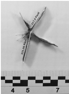
Рис. 2. Вимірювання довжин двох максимальних розривів на фронтальному зрізі желатинового блока
