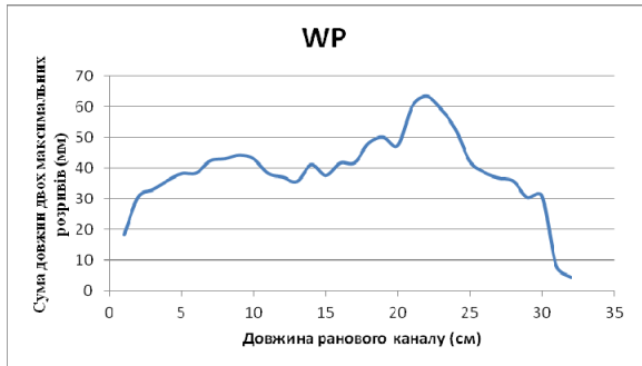
Рис. 3. Характеристика коливань розмірів тимчасової пульсуючої порожнини в желатиновому блоці за методом WP
