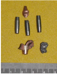
Рис. 19. Фрагменти 5,45 мм модифицированной пули ПС после попадания в имитатор грудной клетки
