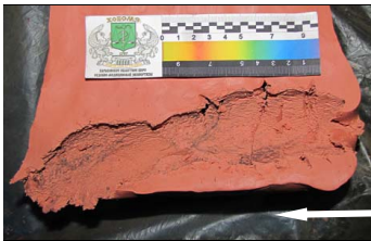
Рис. 12. Характер полости в блоке баллистического пластилина при попадании в него модифицированной 5,45 мм пули ПС (направление движения пули показано стрелкой)
