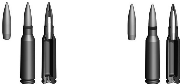
Рис. 1. Общий вид патрона 5,45×39, снаряженного пулей ПС (индекс 7Н6) Рис. 2. Общий вид патрона 5,45×39, снаряженного пулей ПП (индекс 7Н10)
