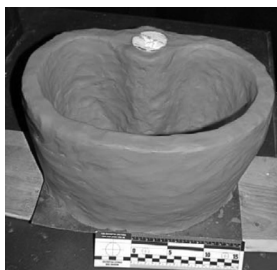
Рис. 7. Общий вид имитатора грудной клетки биологического объекта, изготовленного из баллистического пластилина и полимерного стержня
