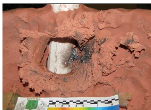
Рис. 16. Характер повреждения внутренней части задней стенки имитатора при попадании в имитатор костной ткани модифицированной 5,45 мм пули ПС
