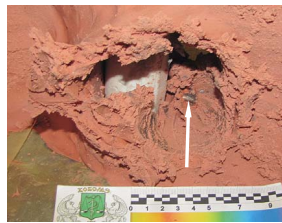
Рис. 15. Характер выходного повреждения задней стенки имитатора грудной клетки при попадании в него модифицированной 5,45 мм пули ПС (вид изнутри, стрелкой указана оболочка пули)
