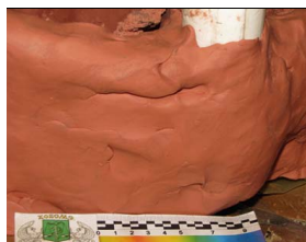
Рис. 17. Характер наружной поверхности задней стенки имитатора грудной клетки при попадании в него модифицированной 5,45 мм пули ПС (повреждение то же, что и на рис. 16)
