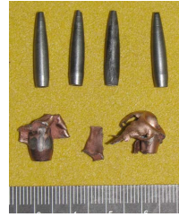
Рис. 20. Фрагменты 5,45 мм модифицированной пули ПП после попадания в имитатор грудной клетки
