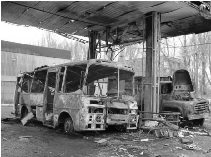
**Рисунок.** Повреждения в результате взрыва метановоздушной смеси автотранспортных средств и строительных конструкций на многотопливном автозаправочном комплексе
