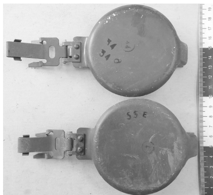
Рис. 3. Задня кришка пускового пристрою гранатомета РПГ-22
