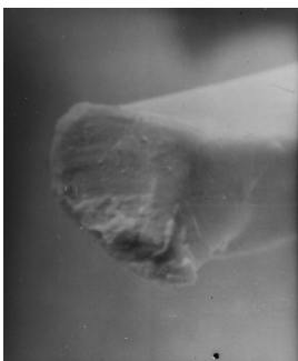
Рис. 1. Волокно, розділене під дією гострого ножа із однобічною заточкою лева при розрізі під прямим кутом
