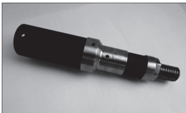
Рисунок 1. Экспериментальный эндо-экзопротез с элементами из углерод-углеродного композитного материала
