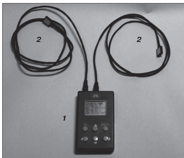
Рисунок 1. Термоелектричний прилад для вимірювання температури і теплових потоків: 1 — блок керування; 2 — термоелектричний сенсор температури і теплового потоку
