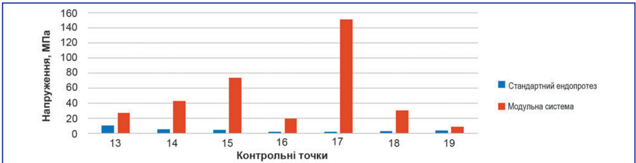
Рисунок 12. Напруження на елементах металевих конструкцій у зоні перелому моделей із переломом типу 2
