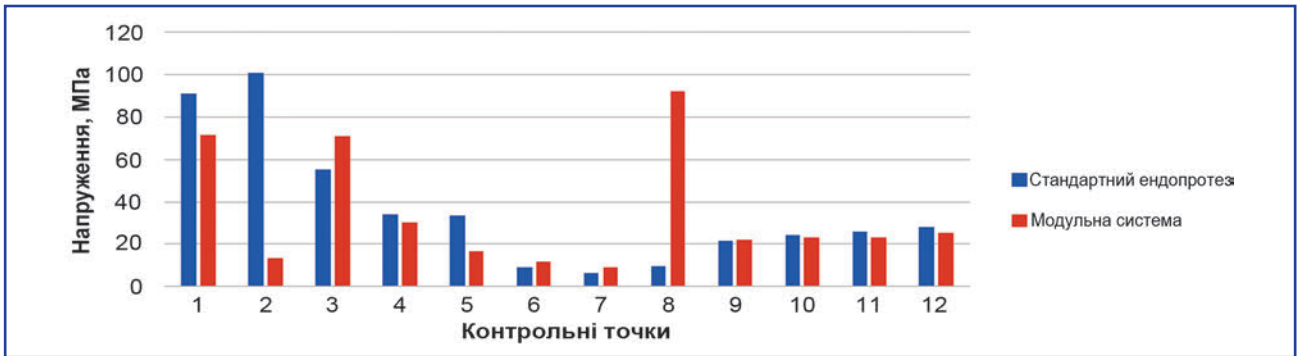
Рисунок 11. Напруження на зовнішній поверхні моделей з переломом типу 2 при ендопротезуванні
