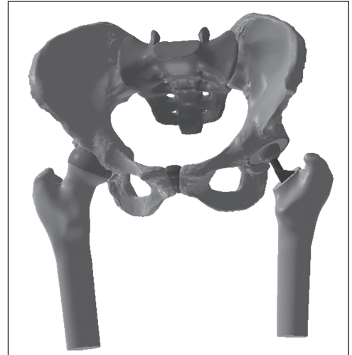
Рисунок 2. Імітаційна модель таза з проксимальними відділами стегнових кісток й ендопротезом
