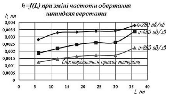
Рис. 6. Графік залежності h = f(L) при зміні частоти обертання шпинделя верстата
