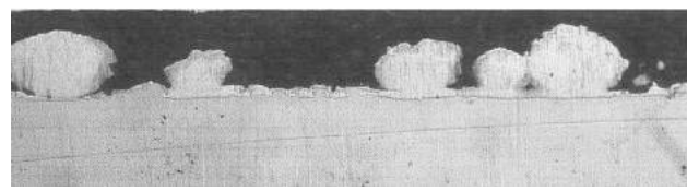
Рис. 6. Микроструктура образца МФЛ марки DU с неравномерным распределением бронзовых гранул (Словакия) (× 100)
