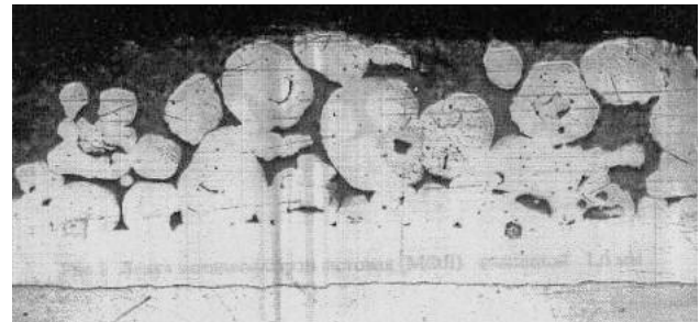
Рис. 3. Микроструктура образцов МФЛ толщиной 1,6 мм (а) и 2,6 мм (б) (ООО «Фторопласт») (× 100)
