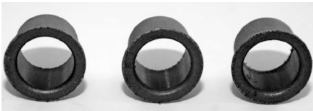
Рис. 12. Свертные втулки с фланцем из МФЛ марки МУ (Италия)
