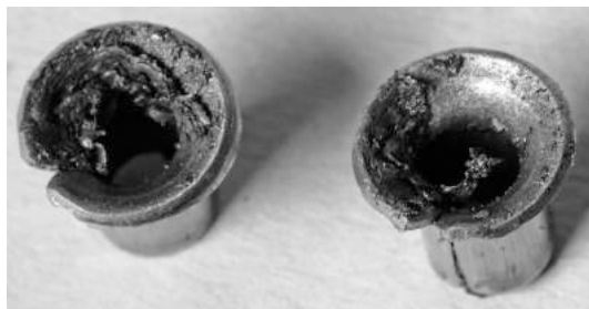
Рис. 20. Заготовки свертных втулок с фланцем с внутренним диаметром 6 мм из МФЛ марки DU(н) толщиной 1,2 мм (Словакия)
