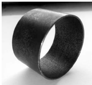
Рис. 28. Антифрикционная бронзовая втулка, пропитанная наполненным фторопластом
