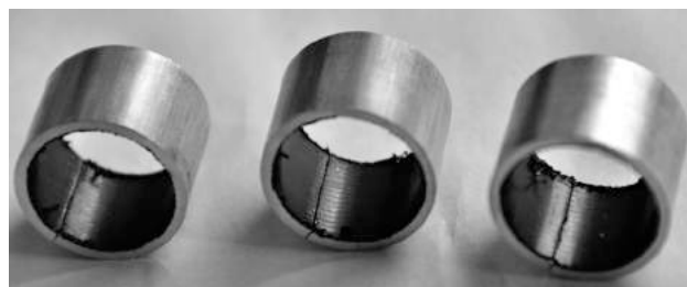
Рис. 23. Свертные втулки без фланца из металлофторопластового материала на основе из алюминиевого сплава АМг-3М (ИПМ НАН Украины)
