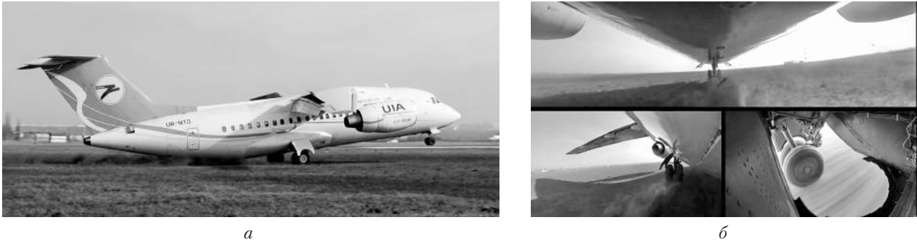
Рис. 1. Взлет самолета Ан-148 с грунтовой взлетно-посадочной полосы
