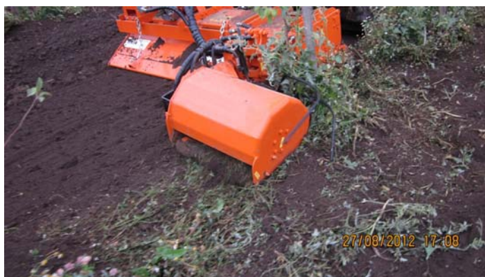
Рисунок 4 – Вдольрядное уничтожение сорной растительности выдвинутой секцией фрезы ФСУ-2,5
