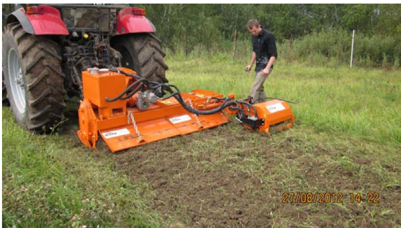
Рисунок 5 – Обработка задерненного участка фрезой ФСУ-2,5
