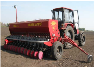
Рисунок 6 – Сівалка зернова механічна СЗМ-4 «Ніка» (ПП ВКФ "Велес Агро")
