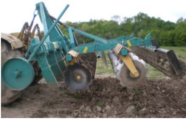
Рисунок 5 – Чизель-дископак ЧД-40 (ТОВ „Краснянське СП „Агромаш”)
