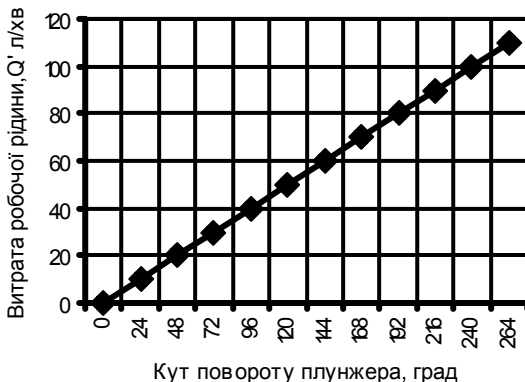
Рисунок 6 – Тарувальна характеристика витратоміра постійного перепаду тиску.
