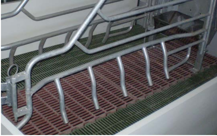
Рисунок 2 – Щілинна підлога з металу в станку для утримання лактуючої свиноматки
