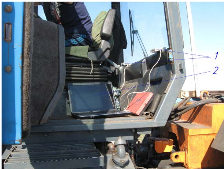
1 – датчики прискорень; 2 – ЕОМ для зняття та архівації даних Рисунок 1 – Розміщення контрольно-вимірювального комплексу в кабіні трактора ХТЗ-17221
