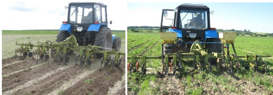
Рисунок 2 – Культиватори для міжрядного обробітку (а) і прикореневого підживлення (б) рослин міскантусу
