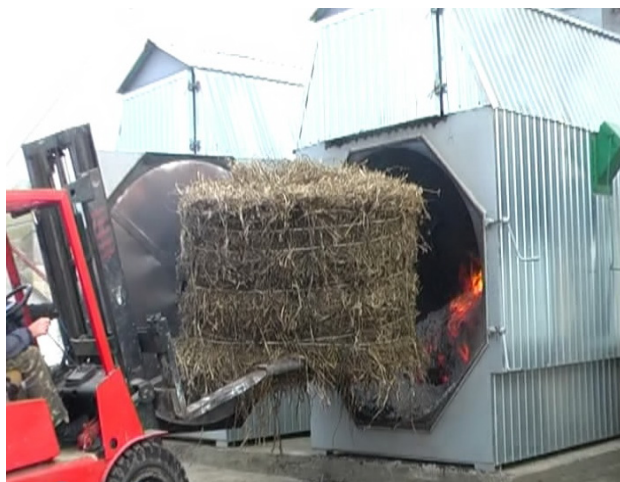
Рисунок 5 – Спалювання рулонів з рисової соломі в теплогенераторі
