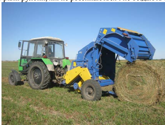
Рисунок 3 – Пресування рисової соломи прес-підбирачем ПРН-145
