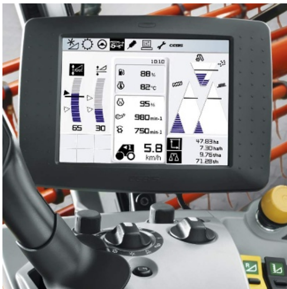
Рисунок 5 – Електронна бортова інформаційна система CEBIS зернозбирального комбайна LEXION 770 від компанії CLAAS
