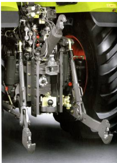
Рисунок 6 – Задня навісна система трактора, ВВП та зчіпний пристрій
