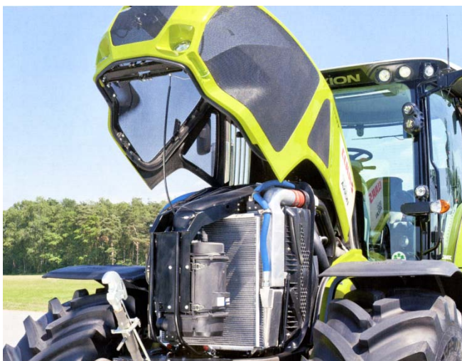
Рисунок 3 – Відкритий капот забезпечує легкий доступ до двигуна
