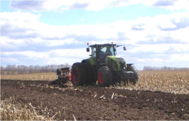
Рисунок 1 – Трактор CLAAS Axion 940 з плугом Vogel & Noot Hercules 1000 в роботі
