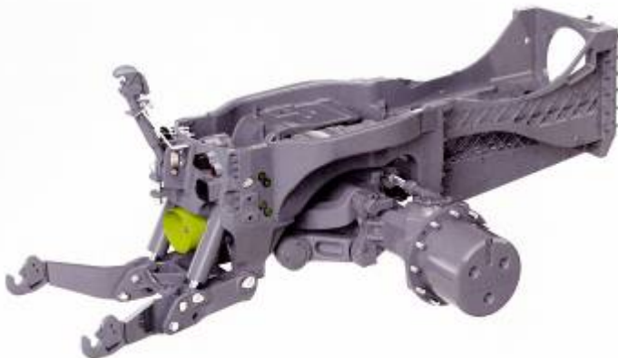
Рисунок 2 – Напіврама трактора з переднім мостом та передньою навісною системою
