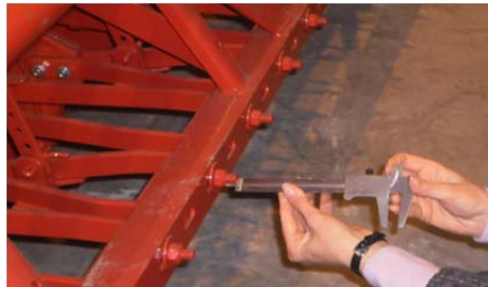
Рисунок 3 – Вимірювання виступу стрижня у кріплення хомутів штанг повідців СЗ-3,6А (2012 р. вип.)
