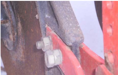
Рисунок 2 – Виступ стрижня болта за межі болта гайки у кріпленні повідця до корпусу сошникової сівалки СЗ-3,6А (2008 р. вип.)
