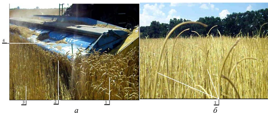
а – утворення екранного ефекту: 1 – необчесані стебла пшениці, 2 – стебла, які утворюють екранний ефект, 3 – стебла з обірваними колосками, 4 – передня частина жатки; б – характер відокремлення колосової частини: 1 – стебла з відірваною колосовою частиною
