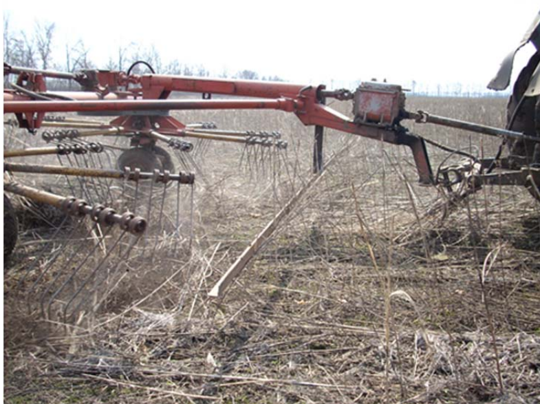
Рисунок 3 – Модернізовані роторні граблі ГРВ-6 в роботі
