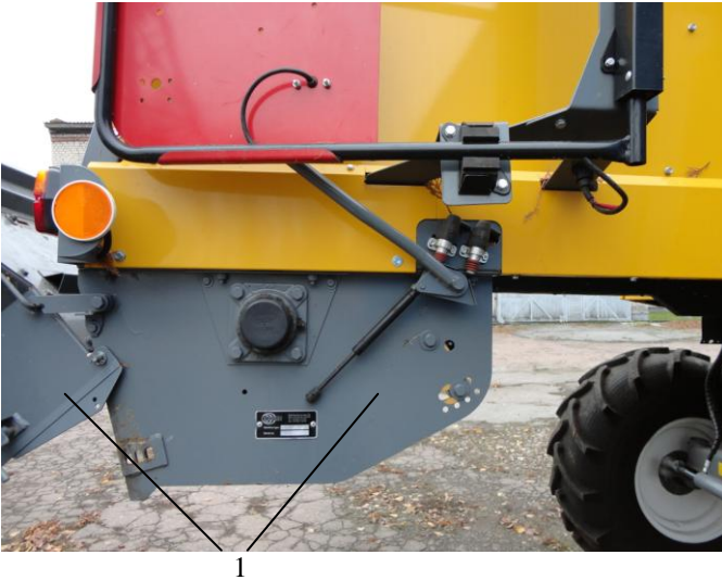
Рисунок 6 – Система «RECORD» (1) для подрібнення та розсівання соломи по полю
