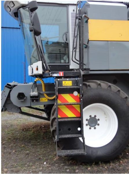
Рисунок 7 – Ергономічна сучасна кабіна має зручний вхід до неї і надійне огороження вхідної площадки
