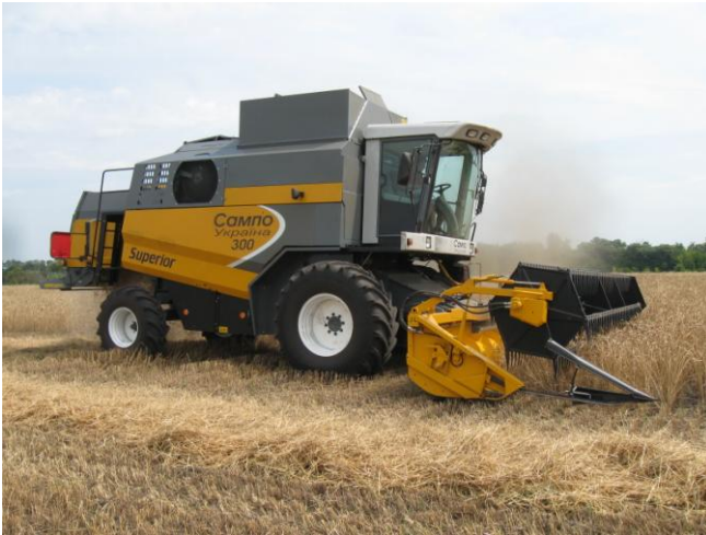
Рисунок 1 – Комбайн SR-3085 «SUPERIOR» (Сампо-Україна – 300) в режимі прямого комбайнування на збиранні озимої пшениці
