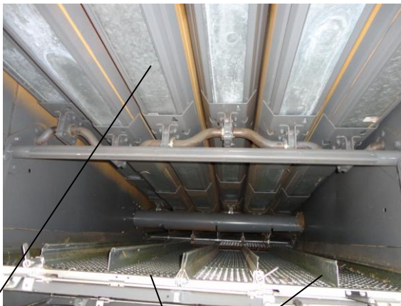
.....1.....2.....3..... Рисунок 5 – Соломотряс у складі 6-ти клавіш (1) та верхнє решето (2) системи очищення зерна з високими вертикальними ребрами (3)
