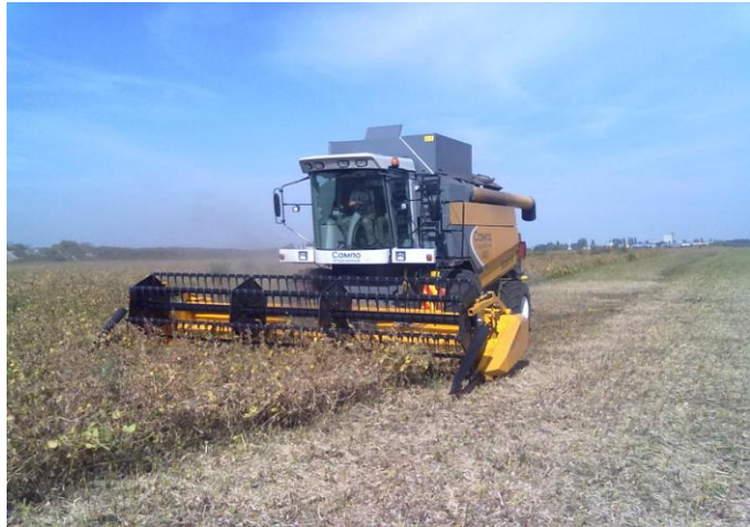
Рисунок 8 – Комбайн SR-3085 «SUPERIOR» в режимі прямого комбайнування збирає сою
