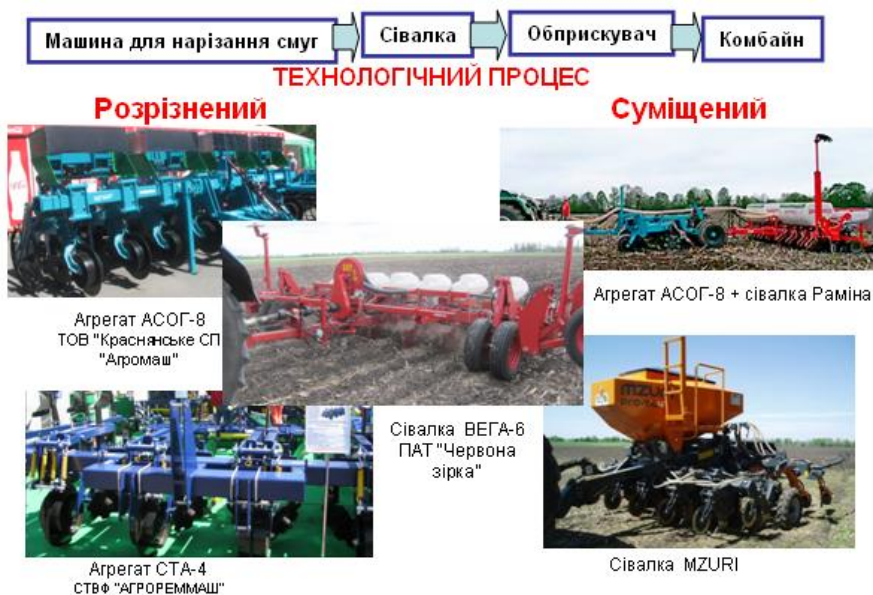
Рисунок 1 - Базовий комплекс машин та принципи реалізації технологічного процесу
