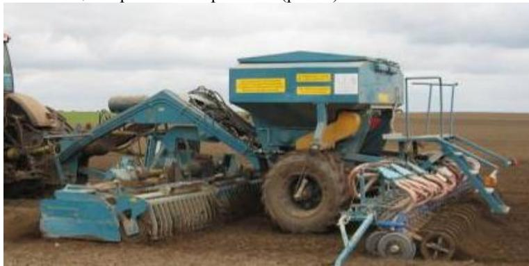
Рисунок 7 – Агрегат почвообрабатывающе-посевной АППА-6
