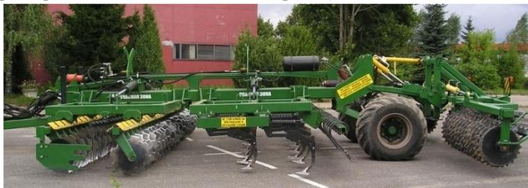
**Рисунок 2 – Агрегат почвообрабатывающий многофункциональный АПМ-6**
