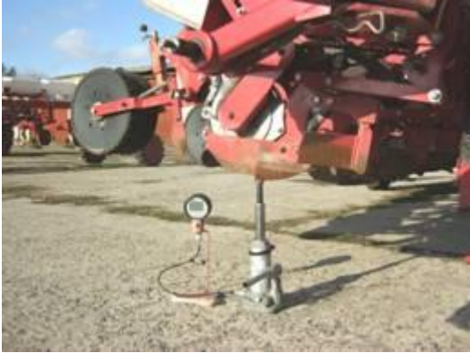
Рисунок 8 - Вимірювання сили тиску сошника сівалки на ґрунт з застосуванням приладу ПВГ-10Е
