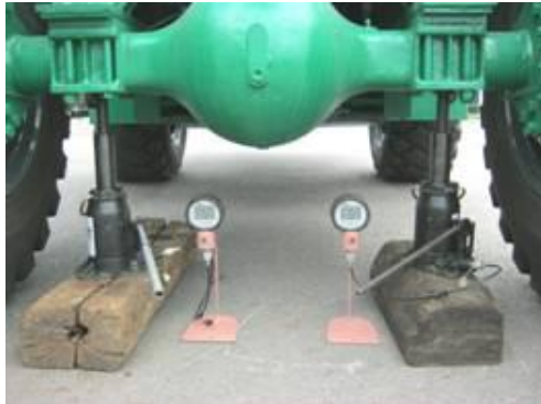
Рисунок 7 - Апробація приладів ваговимірювальних ПВГ-10Е під час зважування фронтального навантажувача РН 936
