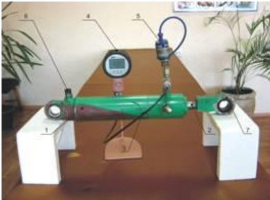
Рисунок 9 - Тягомір гідравлічний з електронно-цифровим манометром
