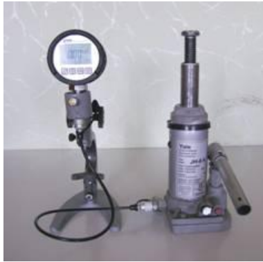
Рисунок 1 – Прилад ваговимірювальний гідравлічний ПВГ-5Е
