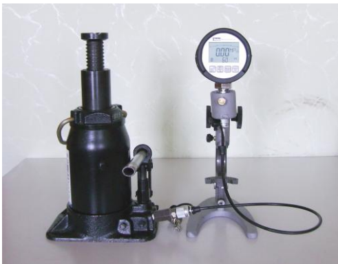
Рисунок 2 – Прилад ваговимірювальний гідравлічний ПВГ-10Е
