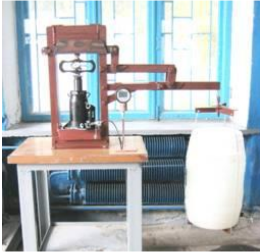
Рисунок 4 - Установка для дослідження залежності тиску робочої рідини в приладі ПВГ-10Е від величини діючих на нього навантажень та для калібрування приладу
