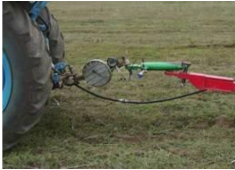
Рисунок 10 - Тягомір гідравлічний з електронно-цифровим манометром в роботі
