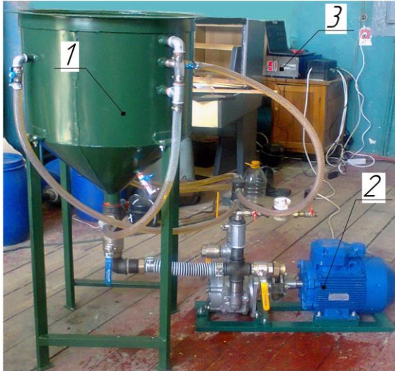
Рисунок 1 - Комплект обладнання для дослідної перевірки енергетичної ефективності виробництва дизельного біопалива в циркуляційних змішувачах
