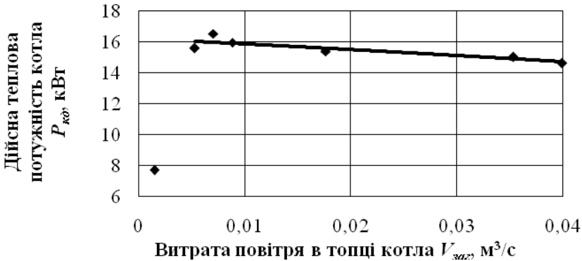
Рисунок 4 - Залежність теплової потужності котла P_{кд} від загальної V_{заг} подачі повітря в робочі області котла
