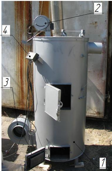
1 – котел КГВ 20; 2 – система подачі повітря в топку котла; 3 – система подачі повітря в нагрівальну порожнину котла; 4 – електронна система керування.
