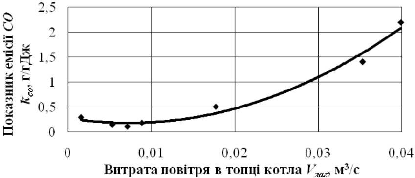
Рисунок 3 - Залежність показника емісії COk_{CO} у димових газах від загальної V_{заг} подачі повітря в робочі області котла
