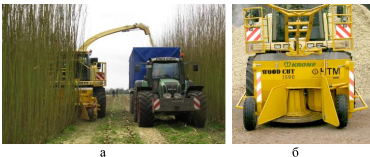
а – збирання верби; б – загальний вигляд адаптера WoodCut 1500. Рисунок 3 - Кормозбиральний комбайн Big X на збиранні верби
