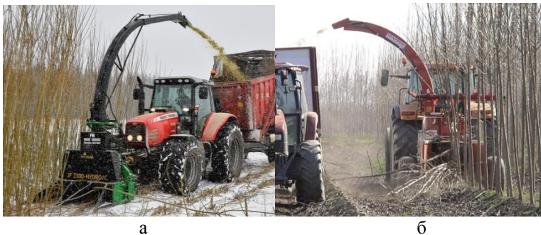
Рисунок 5 - Вербозбиральні комбайни JF Z200-Hydro/C (а) та SPAPPERI RT 500 (б)
